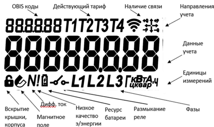
Рисунок 3.3 – Карта сегментов дисплея и их назначение
